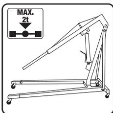
La capacidad máxima de peso es de **2 toneladas**. Verifique siempre el peso del motor y compárelo con la capacidad de carga de la pluma. **Nunca exceda el límite de peso, ya que puede provocar la pérdida de la carga.**
