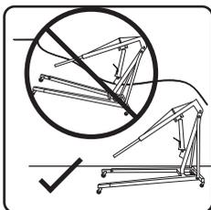
Debe hacer una verificación visual antes de cada utilización de la pluma, para asegurarse que no tenga partes flojas o faltantes, u otras señales de inestabilidad o escapes del fluido hidráulico. Esta pluma está diseñada solamente para levantar motores. **NO** intente levantar cualquier otra pieza pesada de equipo, puede provocar la pérdida o el desequilibrio de la carga.
