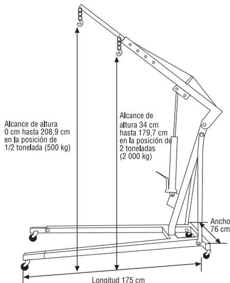
7. Introduzca la extensión para el brazo de levantamiento dentro del brazo de levantamiento, asegurándose de que la ranura para la cadena este dirigida hacia abajo. Fije la extensión con 1 perno, arandela y tuerca. Al hacerlo asegúrese de utilizar el orificio adecuado para la posición, de acuerdo con el trabajo a hacerlo.
