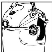
4. Inserte el extremo más grande de la manguera en el puerto de la aspiradora en la cabeza motriz. Presione la boquilla que necesite en el extremo libre de la manguera. (Figs. 5 y 6)
