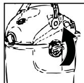
9. Inserte la manguera dentro del puerto del contenedor. (Fig.9)
