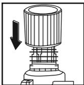
3. Coloque la tapa del filtro sobre el cartucho del filtro y apriételo girando el mango retenedor en la dirección de las manecillas del reloj. (Fig. 3)
