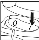
8. Una vez terminado el aspirado, coloque el interruptor en la posición 'O' OFF (apagado) y desenchufe el cable eléctrico del tomacorriente.
