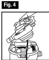
4. Inserte el adaptador en el puerto soplador y coloque los tubos de extensión deseadas y / o las boquillas. (Figs. 5 y 6)
