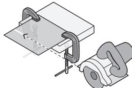
Asegure la pieza de trabajo debidamente con prensas o mordazas antes de iniciar el corte.
