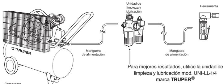
5. Conecte al suministro de aire con un acoplador rápido.
